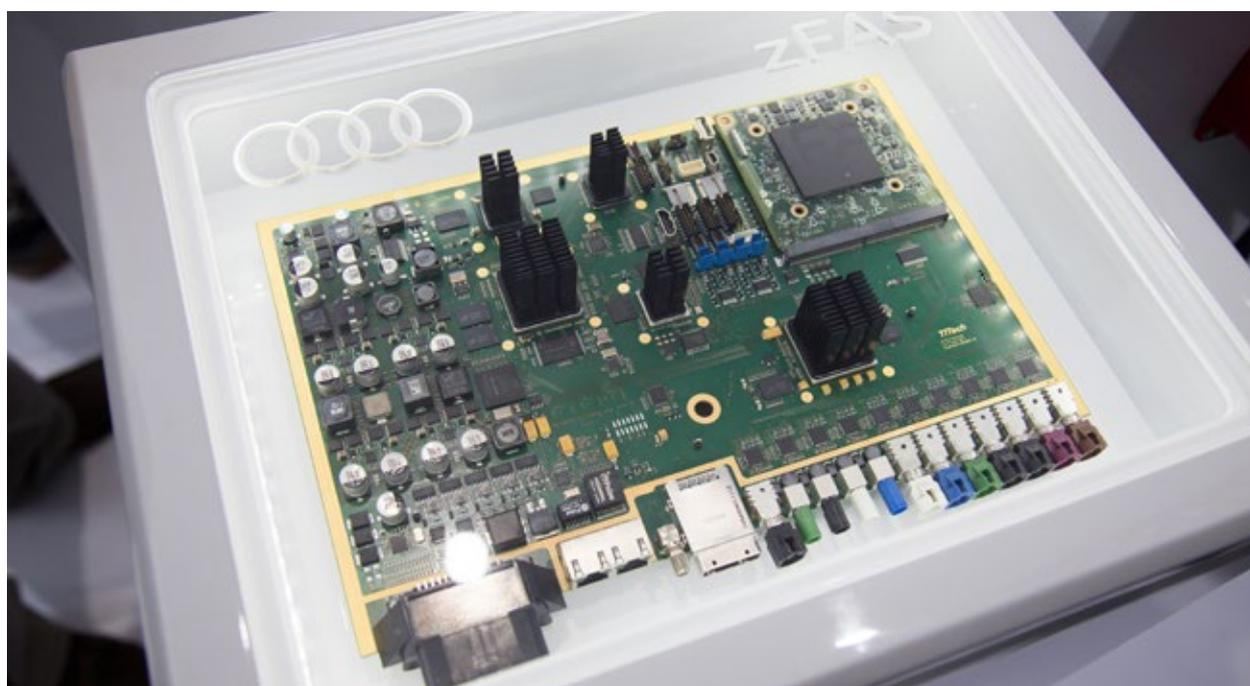
L'Audi Q7 présentée à Las Vegas est capable de s'orienter seul au moyen d'une caméra frontale qui communique avec un processeur NVIDIA. Ce dernier contrôle la direction avec une grande précision via un dispositif de guidage spécialement développé pour la conduite autonome.
