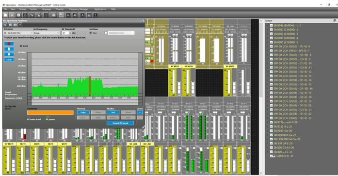
O Spectrum Analyzer fornece informações detalhadas sobre o ambiente de RF em que você está operando
