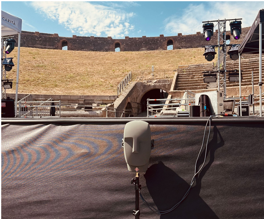
Ein Neumann KU 100 Kunstkopf dient dazu, das Konzert aufzunehmen, damit Bryan Adams es aus der Perspektive des Publikums anhören kann. Bei größeren Shows mit In-Ear-Monitoren wird es auch für den Monitormix verwendet. Foto: Stefan Holtz
