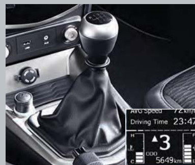
Boîte de vitesses manuelle à 6 rapports (avec indicateur de changement de rapport)
