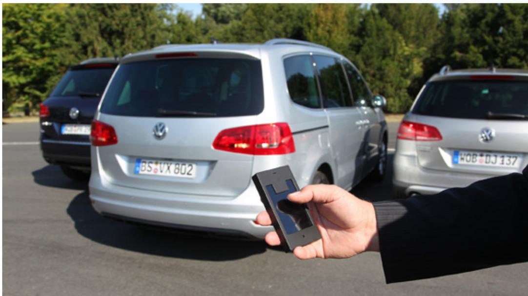
Dans ce genre de situation, le « stationnement télécommandé » de Volkswagen peut se révéler extrêmement utile. Avec ce système, qui requiert une boîte de vitesses à commande électronique (« shift by wire »), le conducteur ne doit plus être au volant pour garer sa voiture ou la sortir de son emplacement.
