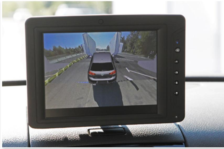
L'affichage « Offroad » s'avère utile lors de déplacements à vitesse réduite sur sol non stabilisé ou en tout-terrain. Grâce aux caméras avant, arrière et latérales, les abords immédiats du véhicule sont visualisés, grâce à quoi le conducteur peut identifier facilement les obstacles présents sur sa trajectoire (grosses pierres, troncs d'arbre, nids-de-poule, etc.).
