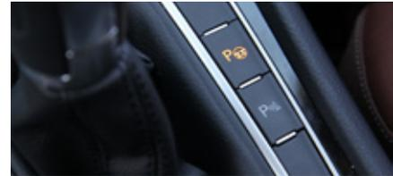
Dès que l'automobiliste sollicite l'accélérateur, l'attelage commence à reculer. Le conducteur peut régler l'orientation de la remorque par degrés à l'aide du bouton de commande. L'angle requis est atteint par pilotage automatique de la direction électromécanique de la voiture. Il est possible à tout moment de corriger la trajectoire souhaitée.
