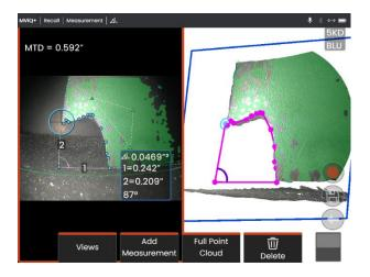
Mentor Visual iQ bietet sofort verfügbare "Learn More"-Inhalte sowie hochauflösende Bildgebung mit Real3D™ Messungen, einschließlich automatisierter Messungen wie "Missing Corner".
