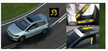
virage ou un sous-virage prononcé et une intervention du système de stabilisation, la pré-tension des ceintures s'accompagne d'une fermeture quasi complète des vitres (et du toit ouvrant). Dans cette position, ces éléments offrent un appui optimal aux airbags rideaux et latéraux.
