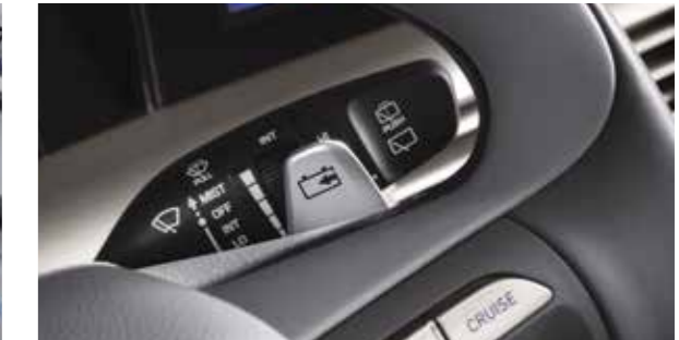
Paddle shift (freinage régénératif)
