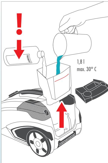
Retirez le réservoir d'eau propre de l'appareil. Remplissez le réservoir d'eau propre vide avec 1,8 litre d'eau propre au maximum (tiède, maximum 30 °C). Replacez le réservoir d'eau propre dans l'appareil. Pour le montage et le démontage du réservoir d'eau propre, cf. chapitre « Nettoyage », section « Nettoyage du réservoir d'eau propre ».
