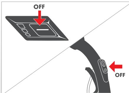
Arrêtez l'appareil en appuyant brièvement sur la touche de démarrage de l'appareil même ou de la télécommande. L'appareil redémarrera au niveau de puissance d'aspiration préalablement sélectionné s'il n'a pas été débranché du secteur.
