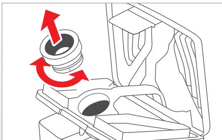
En cas de fort encrassement, retirez l'éjecteur en tournant le joint du raccord pour nettoyage.
