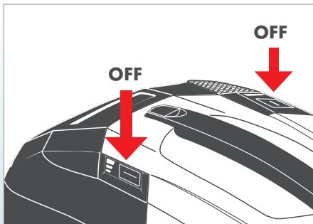
Lorsque le réservoir d'eau propre est vide, ou à la fin du nettoyage, éteignez la pompe en appuyant sur la touche de la pompe.
