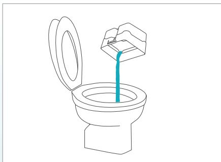
Videz/nettoyez la cuve d'eau usée de l'Aquafilter avant de remplir de nouveau le réservoir d'eau propre comme décrit précédemment (voir chapitre « Nettoyage », section « Nettoyer l'Aquafilter en cas de légère salissure »).
