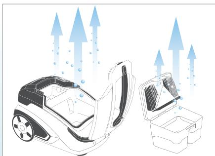
Nettoyez et séchez le système Aquafilter, les suceurs utilisés et le bâti de l'appareil après chaque utilisation.
