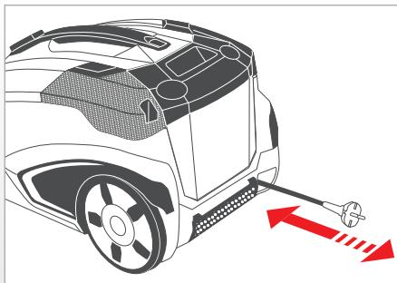
Débranchez la prise du secteur. Tirez légèrement le câble de raccordement en l'éloignant de l'appareil et relâchez-le. Le câble s'enroule automatiquement.
