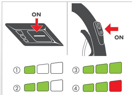
Allumez l'appareil en appuyant brièvement sur la touche de démarrage de l'appareil même ou de la télécommande. L'appareil démarre en mode Éco, ce qui est indiqué par le fait que deux bandes d'affichage vertes s'allument.
