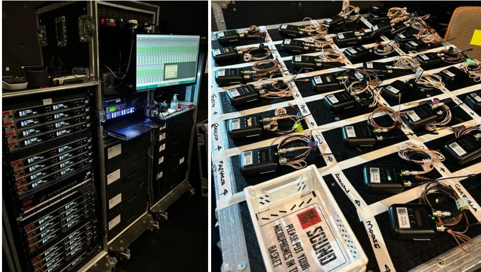
Das Audio-Equipment der Show umfasst neben anderen Sennheiser- und Neumann-Lösungen 14 Sennheiser EM 6000 Zweikanal-Empfänger und 34 Sennheiser SK 6212 Mini-Taschensender. (Bilder mit freundlicher Genehmigung von Aaron Barker)
