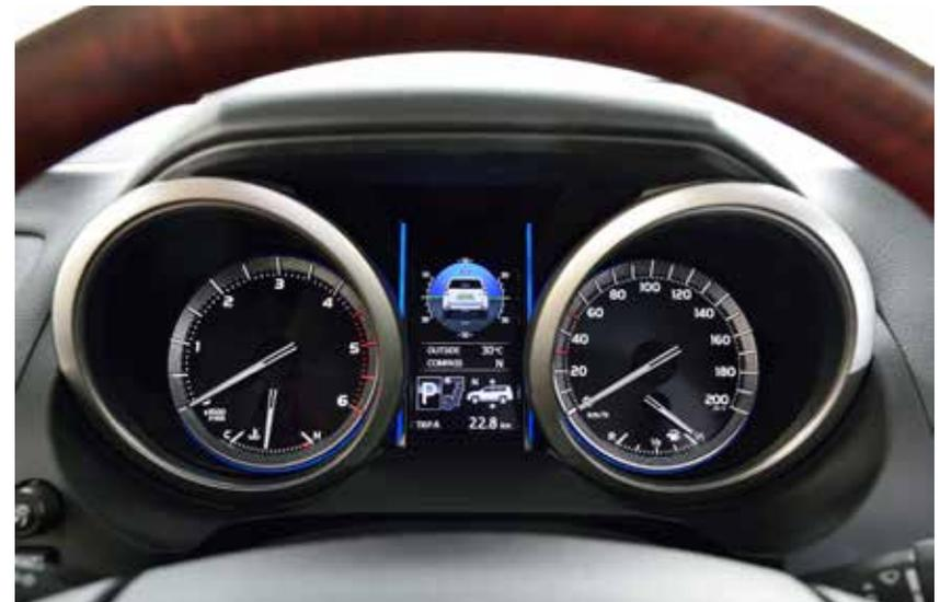
les commandes au volant pour fournir un ensemble d'informations relatives à la marche du véhicule – entre autres le mode et les choix de la Sélection Multi-Terrain, la hauteur des suspensions et le fonctionnement en temps réel des dispositifs tout-terrain.
