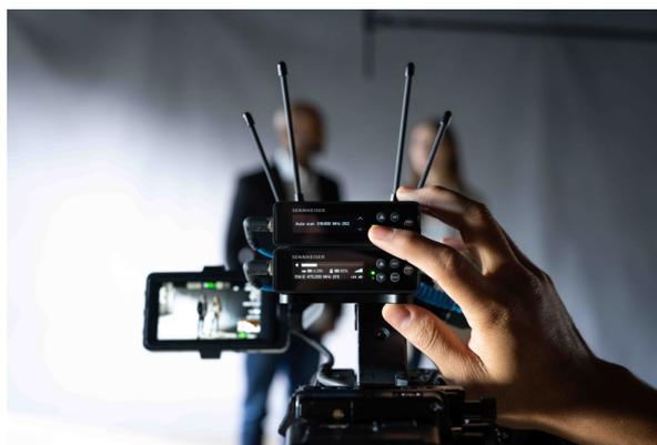
A placa magnética do EW-DP permite que os cineastas empilhem vários receptores de forma simples (e segura). A placa também pode ser usada com o clipe fornecido para prender o receptor no cinto ou a um sound bag (sistema portátil de som direto)
