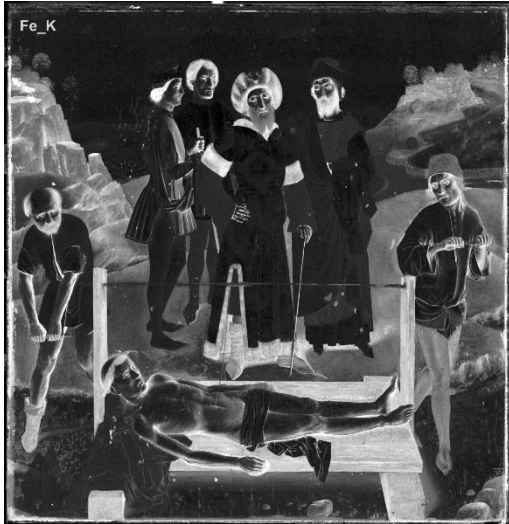
'Triptiek met de marteling van de heilige Erasmus' [macro-XRF, ijzer], Dieric Bouts, ca. 1460-1464, M Leuven / Sint-Pieterskerk © AXIS-Group UAntwerpen, Stijn Legrand, Geert Van der Snickt
