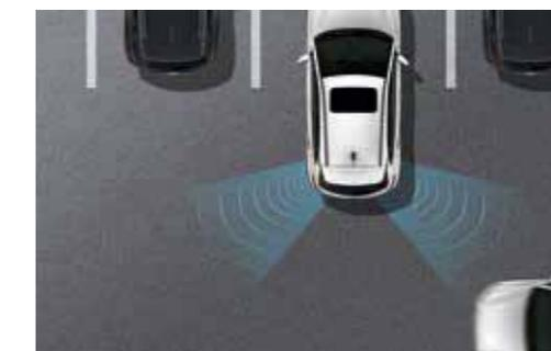
**Rear-Cross Traffic Collision Warning (RCCW)** Lors de la sortie d'une place de parking étroite, ce système diminue le risque de collision. Via deux capteurs radar à l'arrière, vous êtes averti si un véhicule approche.
