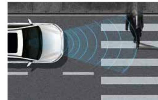
**Forward Collision-Avoidance Assist (FCA) avec détection de piéton** Via la caméra située à l'avant et le capteur radar, le système FCA surveille le trafic pour vous. S'il détecte un risque de collision avec un véhicule ou un piéton, le système vous avertit et, si nécessaire, freine ou arrête la voiture.
