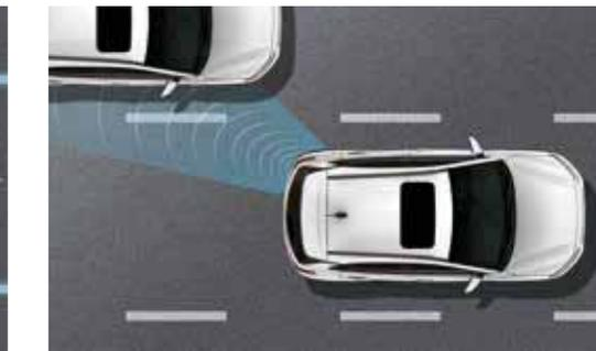
**Blind Spot Collision Warning avec Lane Change Assist** Avec 2 capteurs radar placés au bas du pare-chocs arrière, le système vous avertit visuellement du trafic dans votre angle mort. Si vous activez le clignotant à ce moment-là, un signal sonore retentit.
