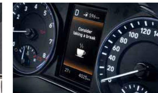
**Driver Attention Warning (DAW)** Ce système installé de série sur le KONA augmente la sécurité et le confort de manière inédite. Il monitorise et analyse en permanence votre comportement au volant. Si le système détecte fatigue ou distraction, il vous avertit par un signal sonore et un message pop-up qui vous conseille de marquer une pause.
