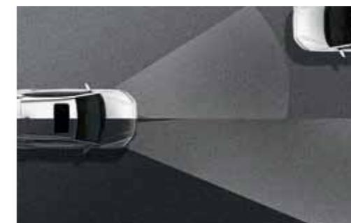
**Technologie d'éclairage Full LED** Lorsqu'il fait sombre, le système High Beam Assist détecte les voitures venant en sens inverse et celles roulant sur la même bande. Les grands phares sont automatiquement allumés et éteints. Les Static Bending Lights projettent un faisceau lumineux aux alentours de la voiture pendant les virages afin d'améliorer la vision nocturne.
