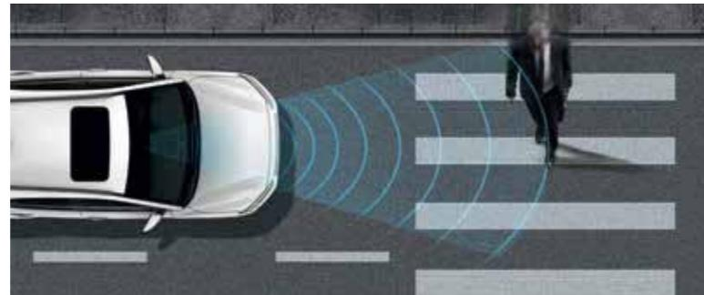
**Forward Collision-avoidance Assist (FCA) avec détection des piétons.** Ce système utilise la caméra avant et le détecteur radar pour surveiller la circulation à l'avant. S'il détecte une collision potentielle avec un véhicule ou un piéton, il avertit le conducteur et si nécessaire, ralentit ou arrête automatiquement la voiture.
