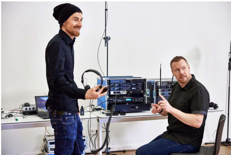
Marco und Jonas mit den HF-Systemen: Schmalband-IEM-Sender und Mikrofonempfänger in der Mitte und rechts; der WMAS-Prototyp (1HE, 19") links
