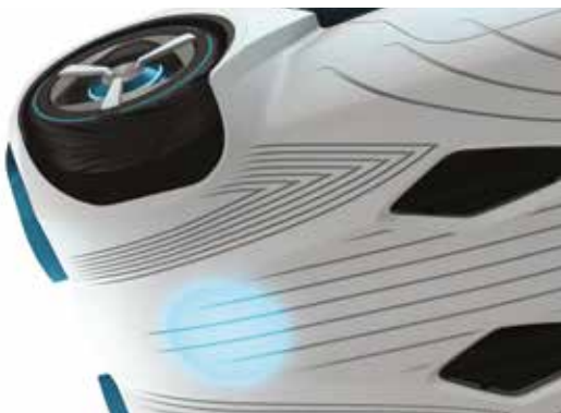
Les panneaux intégrés qui couvrent les roues arrière et le soubassement permettent une recharge externe sans fil intelligente.
