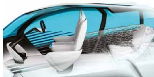
Les habillages intérieurs et les sièges sont conçus selon la même méthode de construction 3D que la structure "squelette" très légère et rigide.
