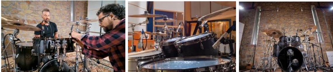
Als Overheads kommen wieder zwei KM 184 Kleinmembranmikrofone zum Einsatz. Das Video zeigt, dass hier statt eines XY-Aufbaus auch eine AB-Konstellation (Laufzeit- statt Pegeldifferenz) sinnvoll sein kann. An der Snare wird ein Neumann KMS 105 genutzt, das eigentlich als hochwertiges Bühnen-Gesangsmikrofon konzipiert wurde, allerdings auch hervorragend an der Snaredrum funktioniert und aufgrund seiner Supernierencharakteristik die HiHat weitgehend ausblendet.
