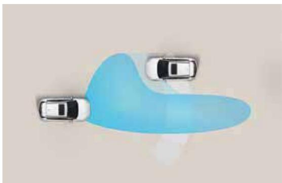
**Technologie d'éclairage Full LED.** Le système d'assistance aux feux de route détecte la circulation en sens inverse ainsi que les voitures dans le même sens lorsqu'il fait nuit. Les feux de route s'allument et s'éteignent ensuite automatiquement. L'éclairage statique de virage éclaire la zone située devant la voiture dans les virages, améliorant ainsi la visibilité de nuit.
