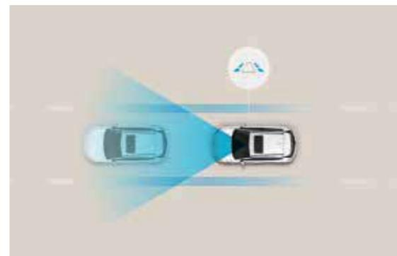
**Lane Following Assist (LFA) avec Adaptive Smart Cruise Control (ASCC).** Le tout nouveau KONA Electric est équipé de l'assistance au suivi de voie. Lorsque le système est activé, il utilise la caméra avant pour garder la voiture au milieu de la voie. Pour un confort de conduite optimal, le LFA fonctionne en combinaison avec le régulateur de vitesse intelligent (à des vitesses comprises entre 0 et 150 km/h).
