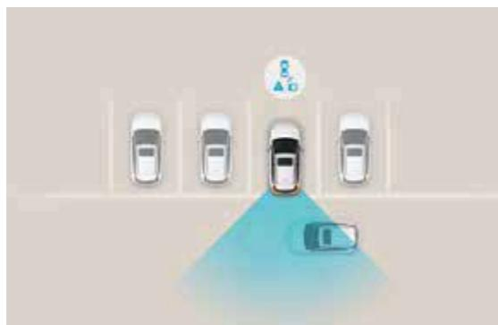
**Rear-Cross Traffic Collision Warning (RCCW).** En quittant un parking étroit, ce système réduit le risque de collision. Par l'intermédiaire de 2 capteurs radar à l'arrière, vous recevez un avertissement à l'approche de la circulation transversale.
