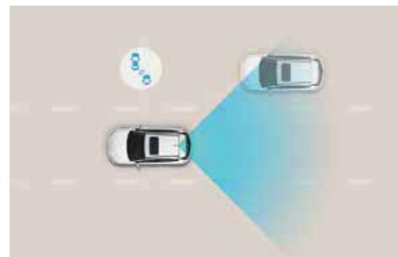
**Blind Spot Collision Warning (BSCW) avec Lane Change Assist (LCA).** Avec 2 capteurs radar au bas du pare-chocs arrière, le système vous avertit visuellement de la circulation dans votre angle mort. Lorsque vous enclenchez votre clignotant à ce moment-là, vous entendez un signal sonore.
