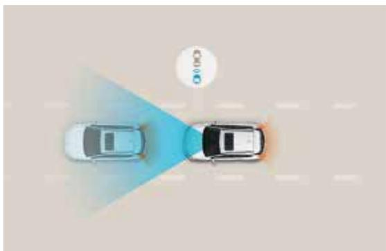
**Forward Collision-Avoidance Assist (FCA) avec reconnaissance des piétons.** Grâce à la caméra frontale et au capteur radar, le système FCA surveille le trafic devant vous. S'il détecte une collision possible avec un véhicule ou un piéton à l'avant, le système vous alerte et le véhicule ralentit ou s'arrête automatiquement si nécessaire.
