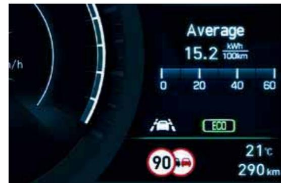
**Intelligent Speed Limit Warning (ISLW).** Le système intelligent d'avertissement de limitation de vitesse utilise la caméra frontale et les informations du système de navigation pour reconnaître les panneaux de vitesse. Il affiche en temps réel sur l'écran du système de navigation et sur l'écran TFT la limitation de vitesse et toute interdiction de dépassement.
