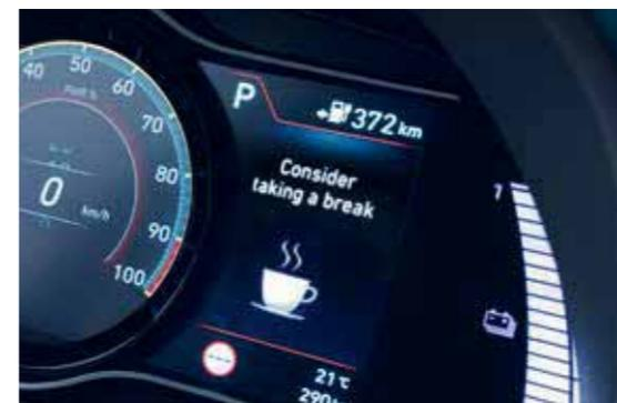
**Driver Attention Warning (DAW).** Ce système est de série et porte la sécurité et le confort à un autre niveau. Il surveille et analyse en permanence votre comportement de conduite. Si le système détecte que vous êtes fatigué ou distrait, vous serez averti par un bip et un message pop-up vous recommandera de faire une pause.
