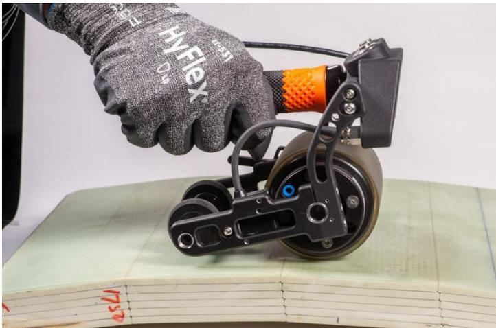
Krautkrämer RotoArray comPact eignet sich für die zerstörungsfreie Ultraschall-Prüfung von Verbundwerkstoffen.
