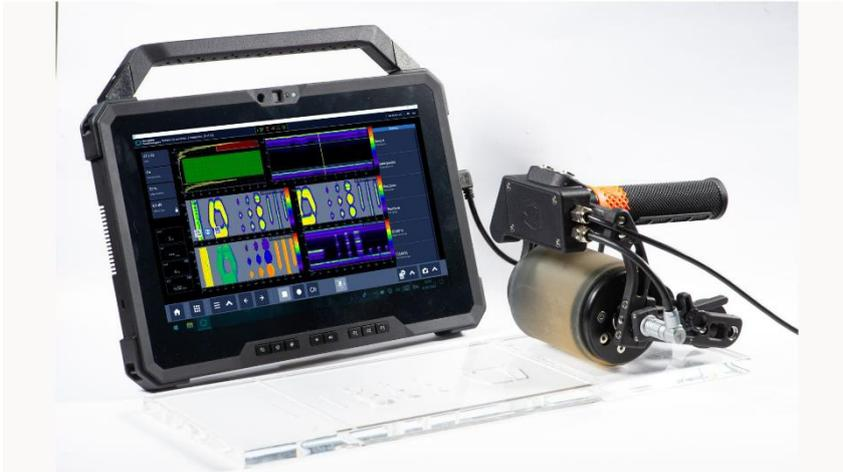
Über einen USB-Anschluss kann Krautkrämer RotoArray comPact mit einem Tablet oder PC verbunden werden.
