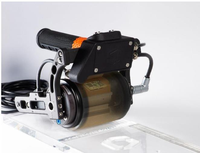
Krautkrämer RotoArray comPact ist das erste Produkt mit integrierter comPact-Technologie von Waygate Technologies. Die auf die Größe eines Chips komprimierte Phased-Array-Elektronik befindet sich direkt im Prüfkopf (Visualisierung).
