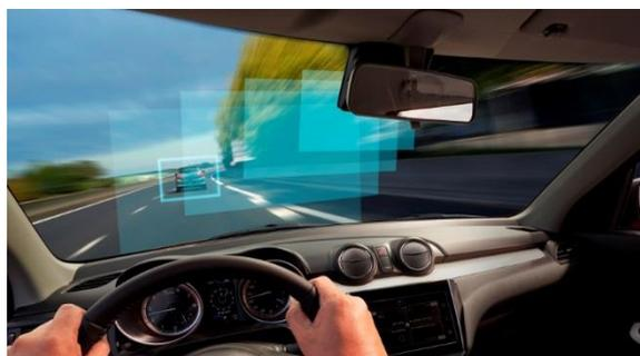
le système détecte qu'il existe un risque élevé de collision avec un obstacle se trouvant en amont et si le conducteur freine brusquement, le système active l'aide au freinage, augmentant ainsi la force de freinage. Si le système détecte que le risque de collision avec un obstacle se trouvant en amont augmente encore, il effectue un freinage automatique appuyé afin d'éviter la collision ou de réduire les dommages.
