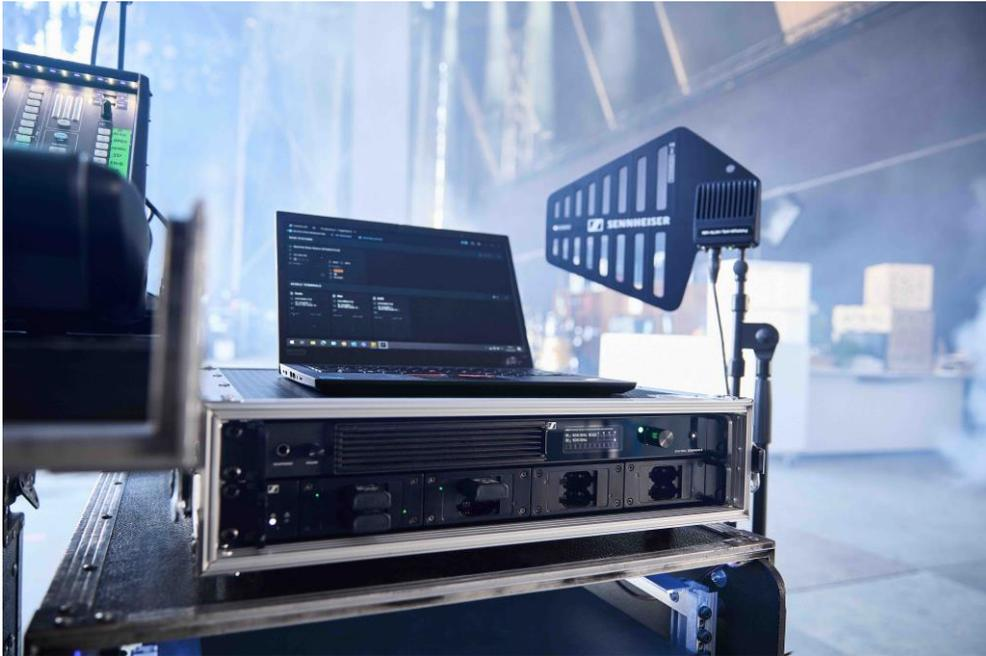
19 インチの 1U ラックのスペースで、マイクと IEM を使った制作が完結。
