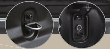
Die Ladefläche ist mit einer stabilen Kunststoffwanne ausgekleidet. Sie bietet Verzurrösen in jeder Ecke sowie eine 12-V-Steckdose nahe der verstärkten Heckklappe.
