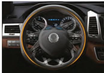
Geschwindigkeitsabhängige Servolenkung und beheizbares Lederlenkrad
