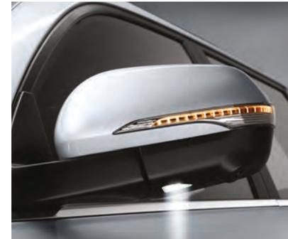
In die Außenspiegel sind die Seitenblinker und die praktische Umfeldbeleuchtung integriert.
