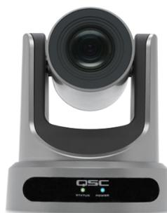
Le microphone TeamConnect Ceiling 2 délivre le signal audio qui contrôle l'orientation de la caméra
