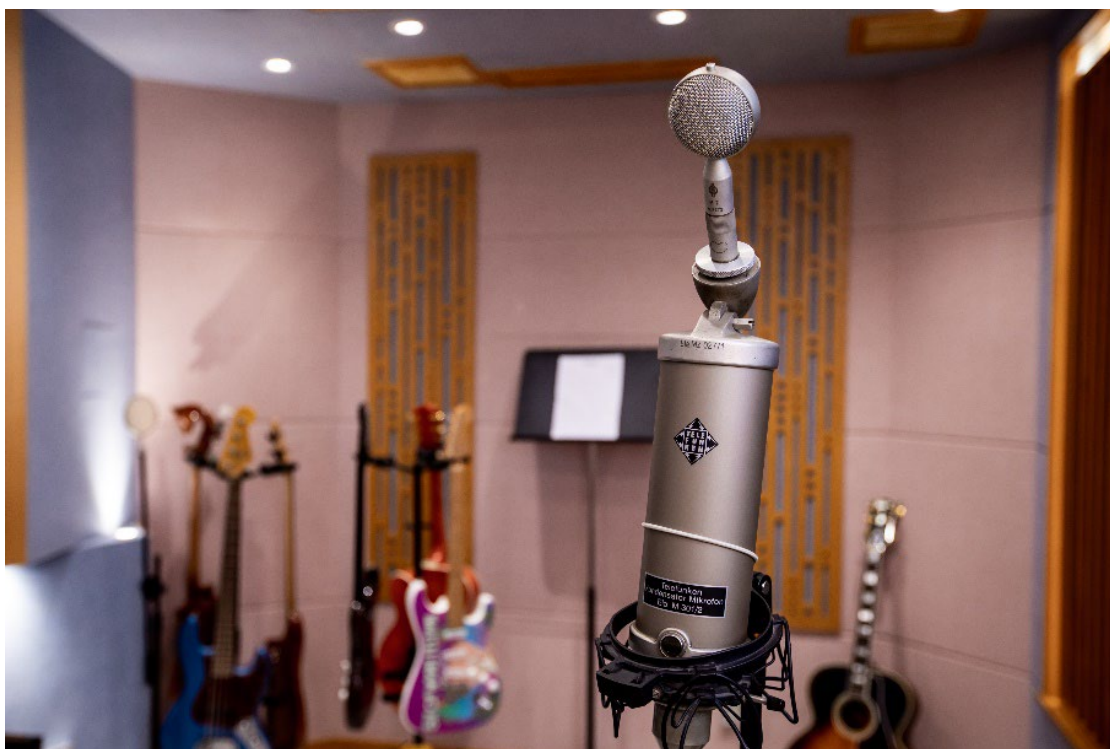
诺音曼 CMV 3——首款批量生产的电容式麦克风
