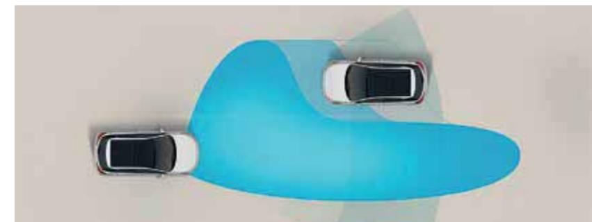
High Beam Assist (HBA) détecte les véhicules arrivant en amont ainsi que ceux qui vous précèdent pendant la nuit. En basculant automatiquement des feux de route aux feux de croisement, le système accroît la sécurité et la visibilité pendant la nuit.
