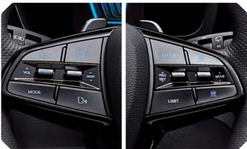
Lenkradfernbedienung für Audiosystem/ Geschwindigkeitsregelanlage
