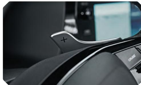
Lenkradschaltwippen (bei Automatikgetriebe)
