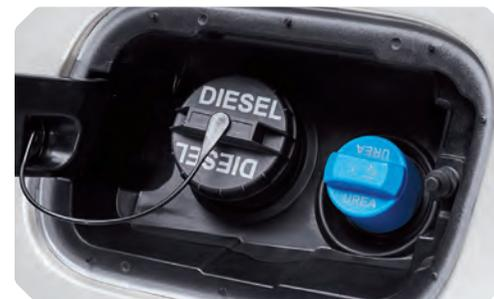
AdBlue Tank (für Fahrzeuge mit Dieselmotor)
