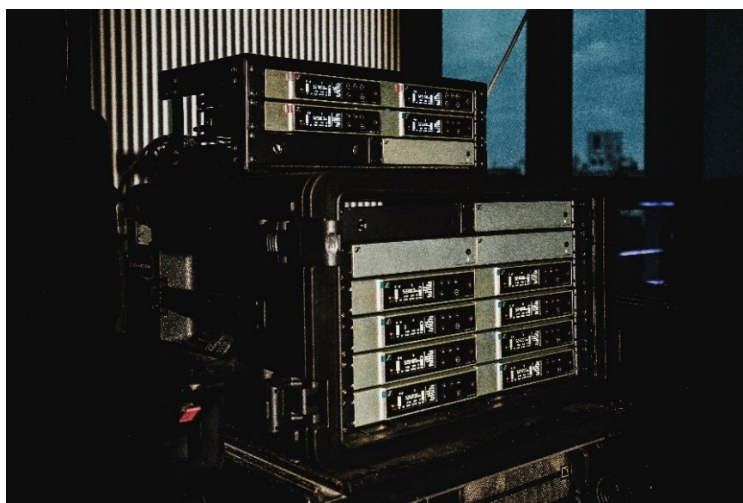
EW-D 系列配备的等间距频点设置能高效利用频谱资源，简化频率协调的工作流程
