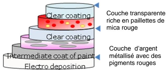
Ce processus innovant complexe comprend une succession de deux étapes de cuisson tandis que des programmes spécialement développés contrôlent l'homogénéité de l'épaisseur des couches et garantissent la qualité de finition.
