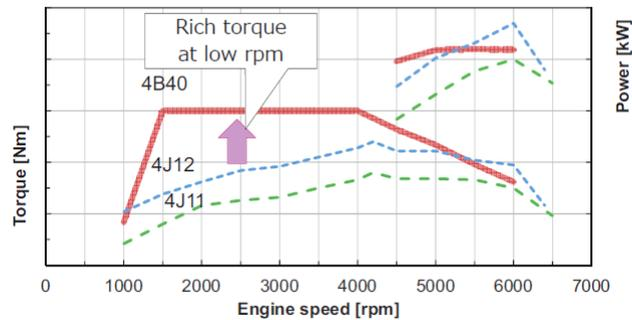
Fait important, ce nouveau moteur 4B40 présente une courbe de couple très plate entre 1 800 et 4 500 tr/min (RON95 spec. Europe) – gage d'une souplesse de fonctionnement et d'une réponse instantanée.
