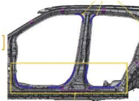
Des « adhésifs » structurels ont été utilisés au niveau des baies de portes, de la baie de hayon arrière et des passages de roue arrière. Il en résulte une rigidité torsionnelle accrue, offrant des sensations plus directes au braquage et améliorant le confort de suspension en réduisant les vibrations.
