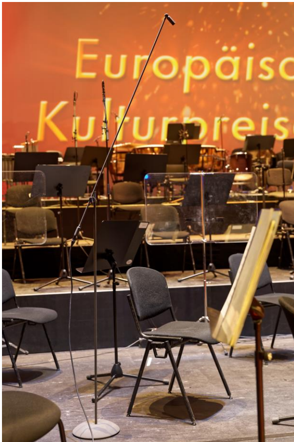
Sennheiser MKH 8040 mit signalführendem Spezialausleger, Stativstange und Bodenstandfuß MZFS 8000
