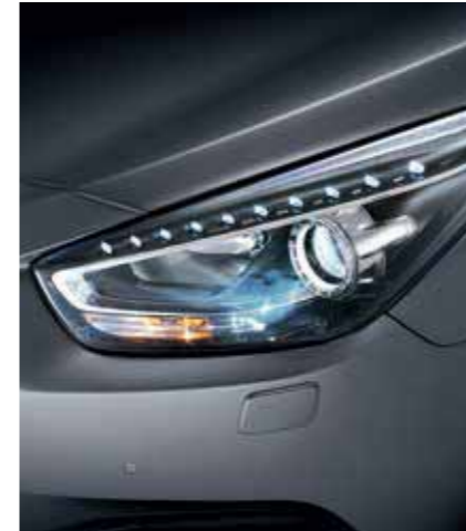
Éclairage de jour LED
