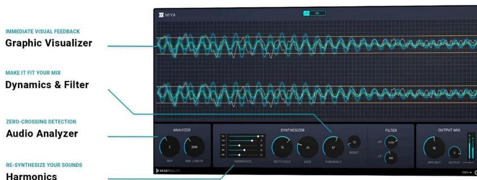
El visualizador en tiempo real de MIYA proporciona información inmediata mediante cuatro colores diferentes. Las líneas verticales naranjas cortas indican los cruces por cero detectados, mientras que una línea gris muestra la señal original entrante. Una línea azul traza la señal generada y una línea verde visualiza la salida del plugin, una mezcla de señales húmedas y secas.
