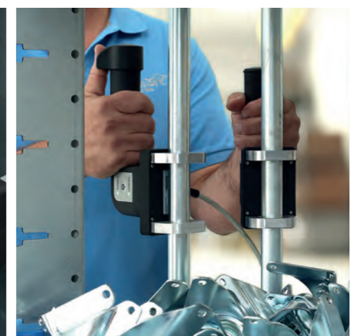
Flexibele montage (horizontaal of verticaal) voor buis of platte opbouwmontage.
