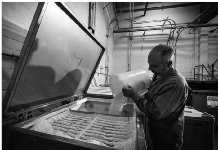
Niko recycle toutes les chutes de thermoplastique issues du processus de production. L'entreprise en réinjecte une partie dans sa propre production tandis que l'autre partie est utilisée par d'autres entreprises. – Collection Niko
