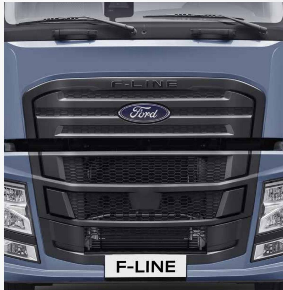
Le pare-chocs avant en plusieurs parties permet de ne remplacer que la partie endommagée, ce qui garantit des réparations rapides et économiques.
