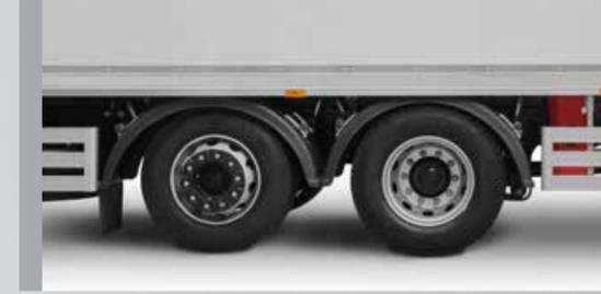
L'essieu arrière directeur, disponible sur nos véhicules 9 litres et 12,7 litres avec configuration d'essieu 6x2, améliore l'expérience de conduite en assurant une maniabilité optimale, même dans les rues les plus étroites.
