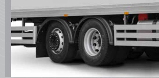
La suspension pneumatique arrière a été spécialement développée pour les modèles 4x2 et 6x2. Cette suspension offre non seulement un confort de conduite inégalé, mais permet également de transporter des chargements sensibles en toute sécurité.
