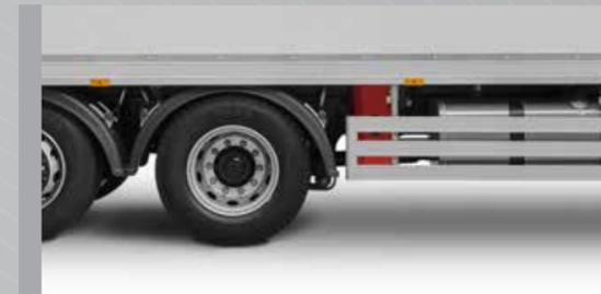
Sur les véhicules à configuration d'essieu 6x2 et 8x2, l'essieu arrière peut être relevé en option lorsque le véhicule n'est pas chargé. Cela permet d'éviter l'usure inutile des pneus. Lorsque vous arrêtez le véhicule pour le charger, les pneus sont automatiquement abaissés grâce à la fonction Auto-Drop.
