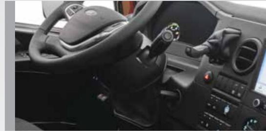
Les véhicules de 420 CH sont équipés d'une transmission automatique à 16 rapports avec des modes de conduite distincts pour un mélange équilibré d'économie et de performance. Quant aux véhicules de 330 CH, ils sont équipés en option d'une transmission automatique à 9 rapports. Cette fonction permet au véhicule de sélectionner automatiquement le rapport le plus approprié, maximisant ainsi l'économie de carburant et les performances.
