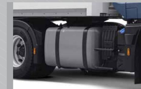
Un réservoir de carburant supplémentaire de 450 litres peut être ajouté au réservoir en aluminium de 600 litres de la version standard du véhicule 4x2. La version 6x4 dispose d'un réservoir de 400 litres et d'un réservoir de 920 litres en option. Cette option vous permet de rouler plus loin sans devoir refaire le plein.
