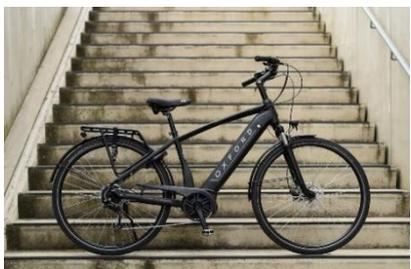
Un VAE sportif avec un design résolument d'aujourd'hui. Le puissant système Smart Bosch Performance Line (75 Nm) est combiné ici avec un engrenage Shimano 9V pour garantir une conduite dynamique. La batterie Bosch Power Tube 500 Wh est entièrement protégée et dissimulée dans le cadre. Idéal, pour les trajets quotidiens maison-travail ou pour les loisirs.
