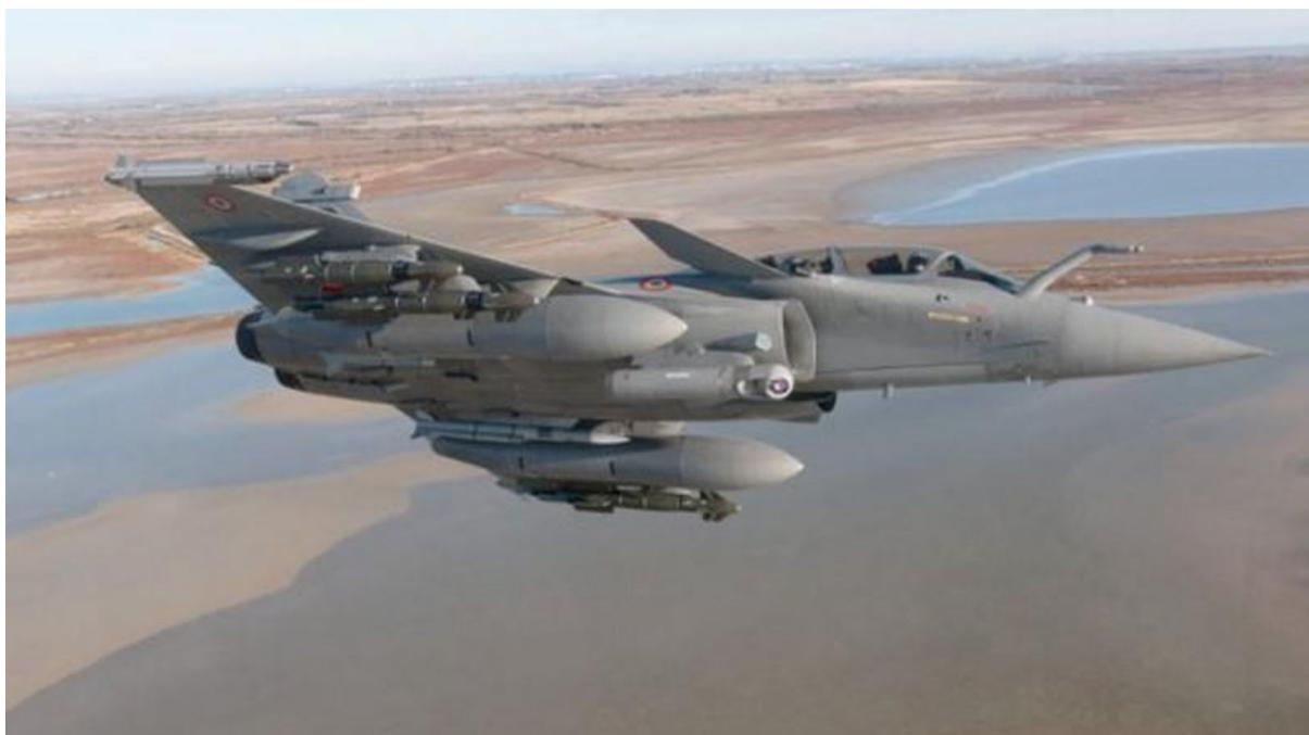
Rafale B en vol avec : 6 AASM, 2 Mica IR point externe, 2 Meteor latéral arrière, 2 bidons 2000L, 1 nacelle Talios
