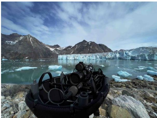
Beverlys Rig besteht aus einem Blimp mit zwei MKH 8040 für das Mittensignal vorn und hinten sowie einem MKH 30 als Seitenmikrofon
