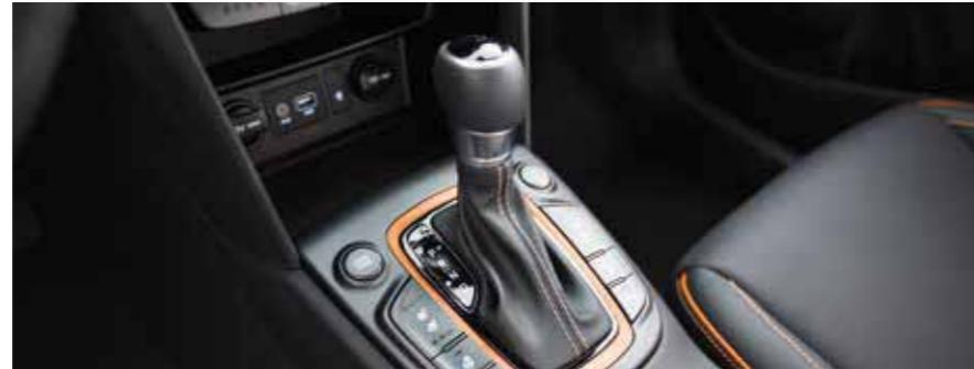
Boîte automatique 7 vitesses à double embrayage (7DCT)
