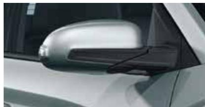
Rétroviseurs extérieurs électriques chauffants avec clignotants LED
