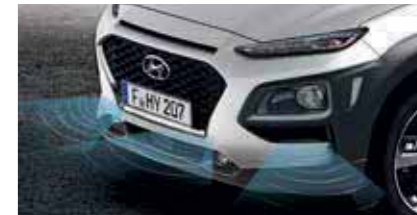
Capteurs de parking à l'avant (FPAS)
