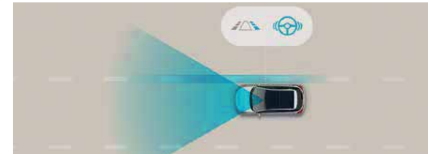
Lane Keep Assist (LKA) Lorsque l'Assistance active de Maintien de Trajectoire remarque que votre voiture quitte sa bande de circulation, elle vous prévient ou modifie activement la trajectoire pour maintenir le véhicule sur sa bande.
