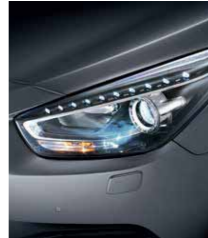
Éclairage de jour LED
