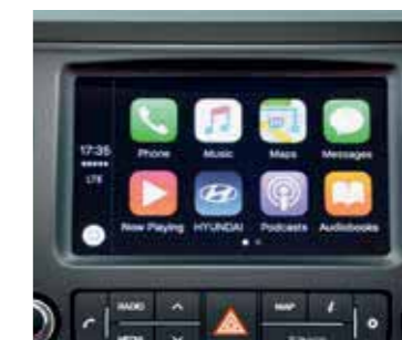
Smart Device Integration. Une fois connectés à votre smartphone, ces systèmes vous permettent d'obtenir des itinéraires, de passer des appels, d'envoyer ou de recevoir des messages et d'écouter de la musique par le biais de l'écran 7".
