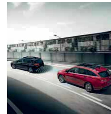
Advanced Smart Cruise Control (ASCC) maintient une distance de sécurité entre le véhicule de devant et ralentit ou accélère lorsque nécessaire.
