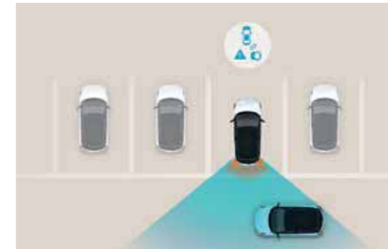
Rear Cross-traffic Collision-avoidance Assist (RCCA) En quittant un parking étroit, ce système réduit le risque de collision. Par l'intermédiaire de 2 capteurs radar à l'arrière, vous recevez un avertissement à l'approche de la circulation transversale et la voiture freine automatiquement si nécessaire..
