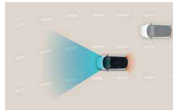
Navigation-based Smart Cruise Control (NSCC) Via le système de navigation de pointe, le système anticipe les virages ou les lignes droites à venir et adapte automatiquement la vitesse pour une expérience de conduite plus sûre
