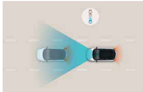
Forward Collision-avoidance Assist (FCA) Via la caméra située à l'avant et le capteur radar, le système FCA surveille le trafic pour vous. S'il détecte un risque de collision avec un véhicule ou un piéton, le système vous avertit et, si nécessaire, freine ou arrête la voiture à partir de 10km/h ou plus.
