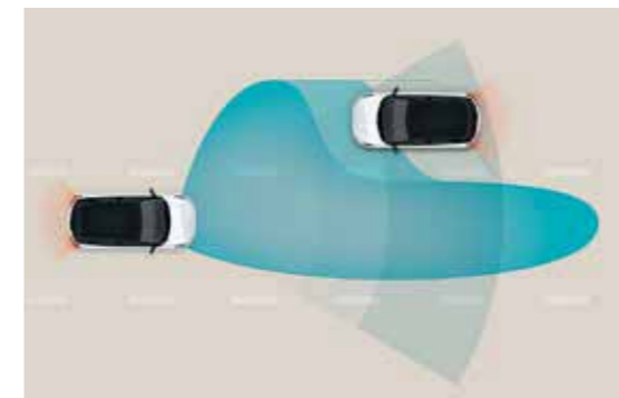
High Beam Assist (HBA) Détection des véhicules arrivant en amont ainsi que ceux qui vous précèdent pendant la nuit. En basculant automatiquement des feux de route aux feux de croisement, le système accroît la sécurité et la visibilité pendant la nuit.
