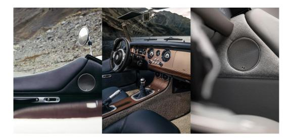
Le système comporte huit transducteurs : quatre enceintes classiques au niveau des portières et du coffre et quatre enceintes invisibles, dont trois derrière le tableau de bord et une dans le compartiment inférieur pour la reproduction des basses. Tous sont pilotés par un nouvel amplificateur avec DSP dédié équipé du logiciel de traitement audio Sennheiser.
