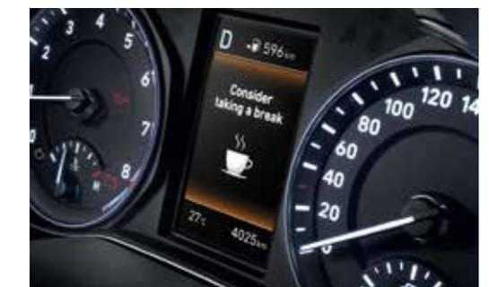
**Driver Attention Warning (DAW)** Ce système installé de série sur le KONA augmente la sécurité et le confort de manière inédite. Il monitoré et analyse en permanence votre comportement au volant. Si le système détecte fatigue ou distraction, il vous avertit par un signal sonore et un message pop-up qui vous conseille de marquer une pause.
