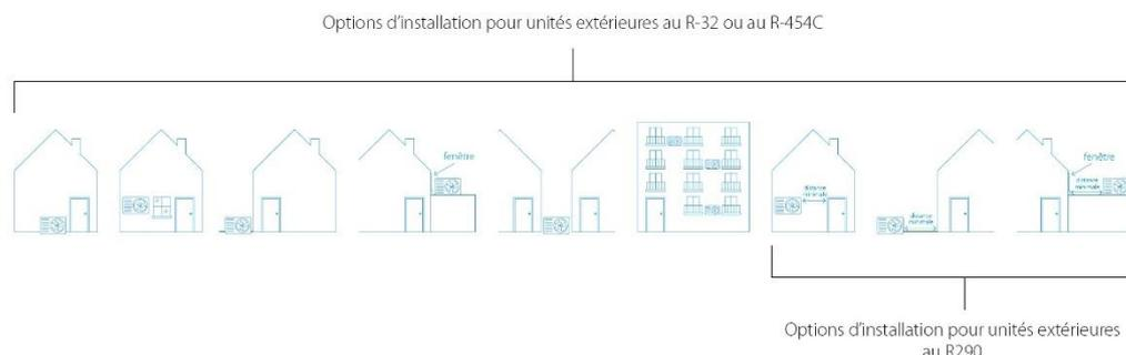
En raison de la haute inflammabilité du propane (A3), des distances minimales doivent être maintenues entre les systèmes au propane et les portes, les fenêtres, les voisins, etc., tandis que des alternatives peuvent s'avérer plus flexibles sur ce plan. © Daikin
