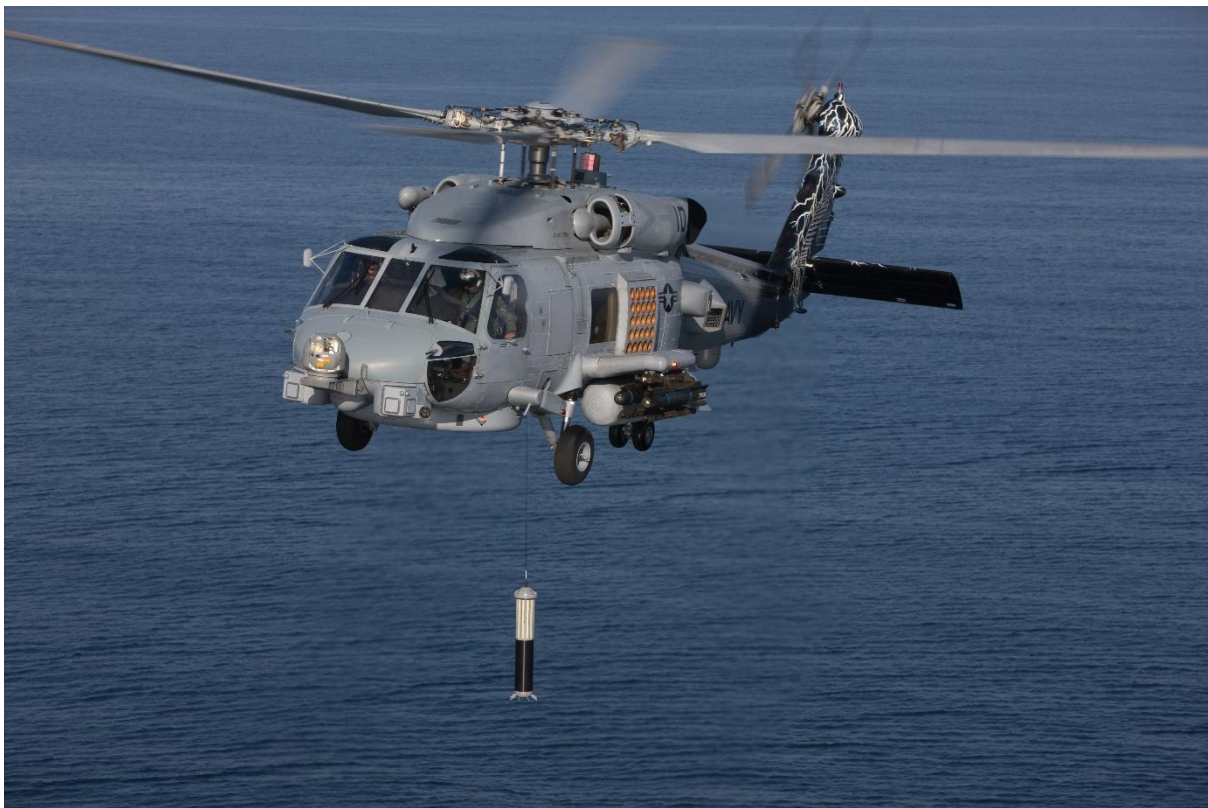
Sonar trempé ALFS embarqué sur hélicoptère MH-60R ©Lockheed Martin
