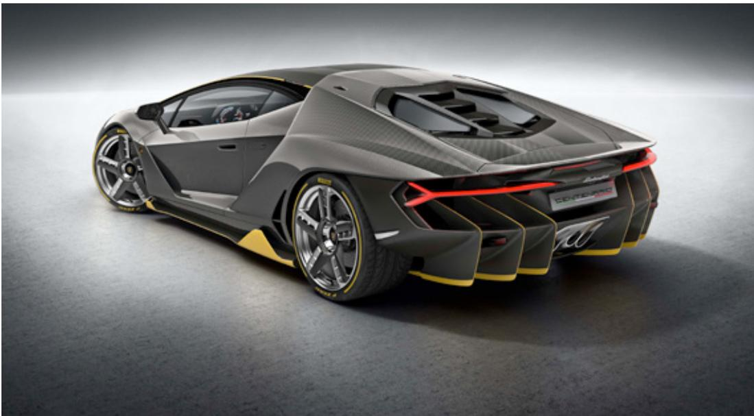
La carrosserie de la Centenario est réalisée en fibres de carbone à finition brillante. Le capot avant, les portes en élytre (toujours réservées aux modèles à moteur V12) et la ligne de toit s'écoulent de manière fluide, aérodynamique et organique : les parties inférieures en fibres de carbone à finition mate (à savoir la lèvre aérodynamique avant, ou « splitter », les jupes latérales, les arches de roue et le diffuseur arrière) sont fonctionnelles et au service de l'aérodynamisme.
