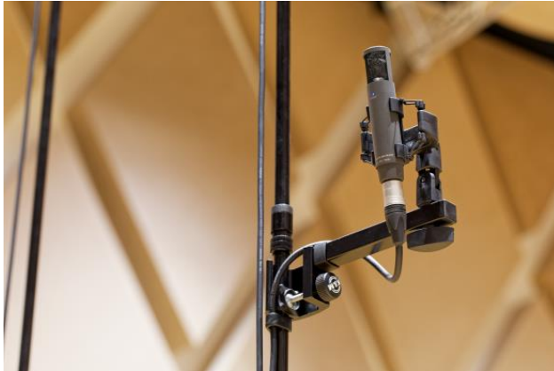
Das Sennheiser MKH 800 TWIN ist mit einer Doppelkapsel ausgestattet und stellt zwei separate Ausgangssignale bereit
