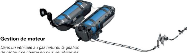
Dans un véhicule au gaz naturel, la gestion de moteur se charge en plus de piloter les vannes d'injection de gaz et le régulateur électronique de pression d'injection de gaz. L'unité de gestion reconnaît également si le gaz dont la voiture a « fait le plein » est du « H-Gas » ou du « L-Gas » (gaz « riche » ou « pauvre »), adaptant en conséquence la durée d'injection. Une efficacité maximale est ainsi garantie.
