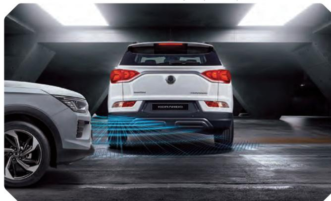
**SYSTÈME DE FREINAGE AUTOMATIQUE (AEBS)** Jusqu'à 60 km/h, s'il détecte la présence d'un piéton ou d'un autre véhicule sur votre trajectoire, l'AEBS désactive l'accélérateur et actionne les freins pour réduire le risque d'accident grave.
