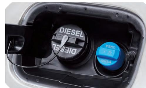
Bouchon de remplissage AdBlue (pour les modèles équipés d'un moteur diesel)
