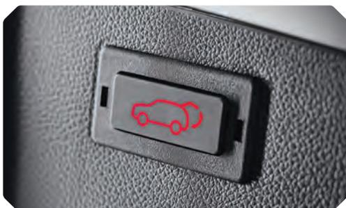
Commande du hayon arrière électrique
