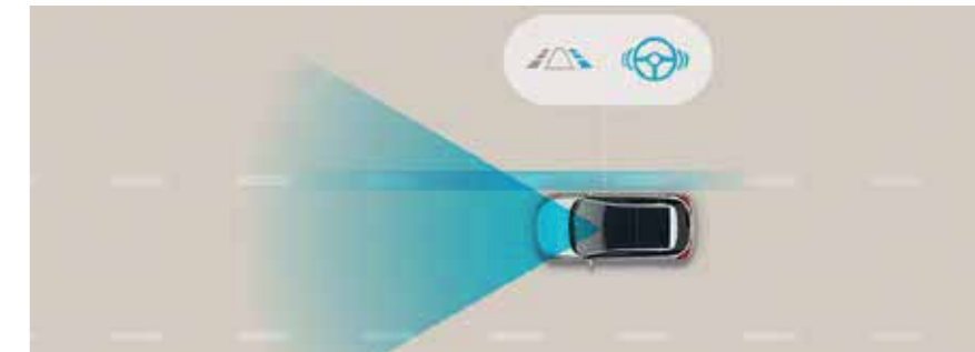
Lane Keeping Assist (LKA) Wanneer de standaard rijstrookassistent merkt dat de wagen onbedoeld afwijkt van zijn rijvak, waarschuwt hij je of stuurt actief bij om de wagen in zijn rijvak te houden vanaf 60 km/u.
