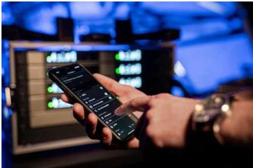
Технология от радиосистем «старших» серий Sennheiser оставляет необходимость расчёта радиочастот в прошлом. Просто просканируйте радиоэфир с помощью приложения и раздайте свободные частоты приёмникам.
